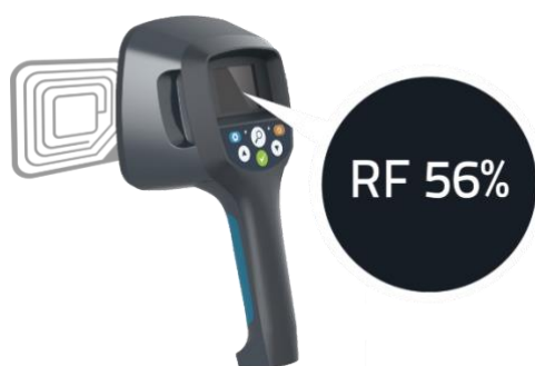
Figur 1 Sensor (t.v.) som avläses med en handhållen läsare. 2
