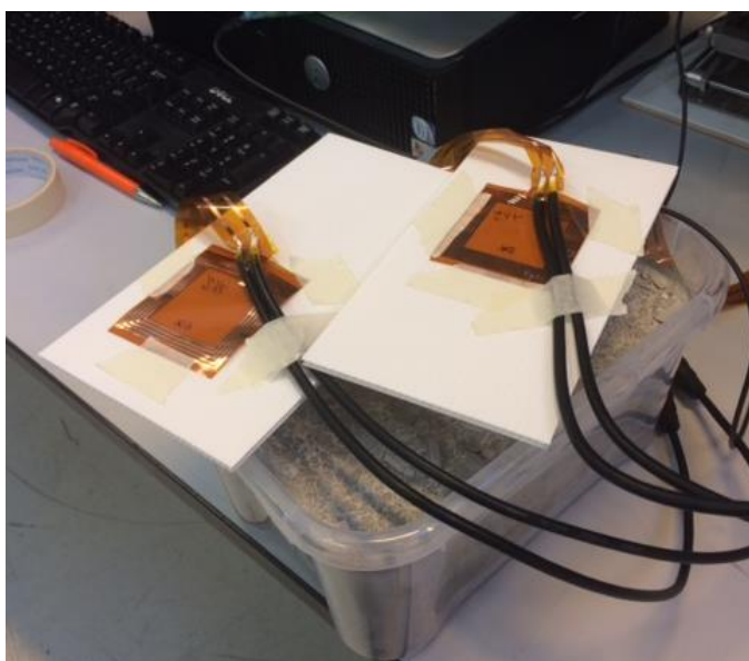
Figur 6 Två sensorer ingjutna i betong anslutna till en frekvensanalysator med mätkablar (svarta). Mätuppställningen stabiliseras genom att antenner och kablar monterats på två pappskivor.
