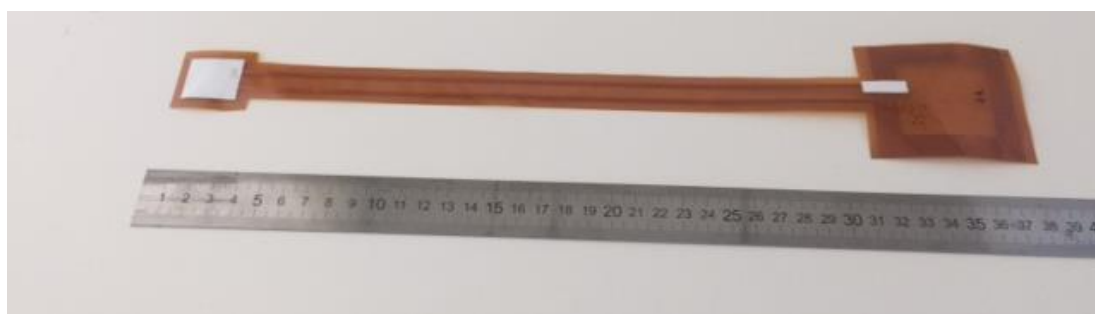
Figur 4 Sensortag med sensordelen (för ingjutning) till vänster och antenndelen (för kommunikation) till höger. Antennens inre ände är förbunden med den långa ledarbanan i koppar via två genomföringar (Ag-trycket till höger). Den totala längden är 380mm.
